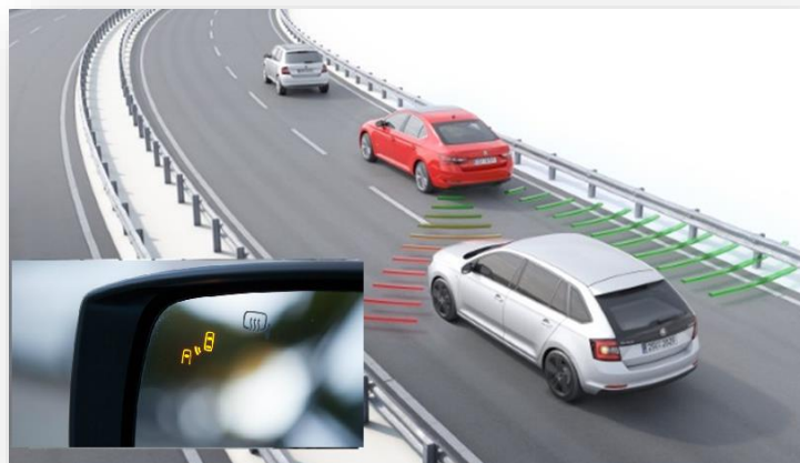
شکل ۱۰: نحوه عملکرد سیستم پایش نقاط کور خودرو
